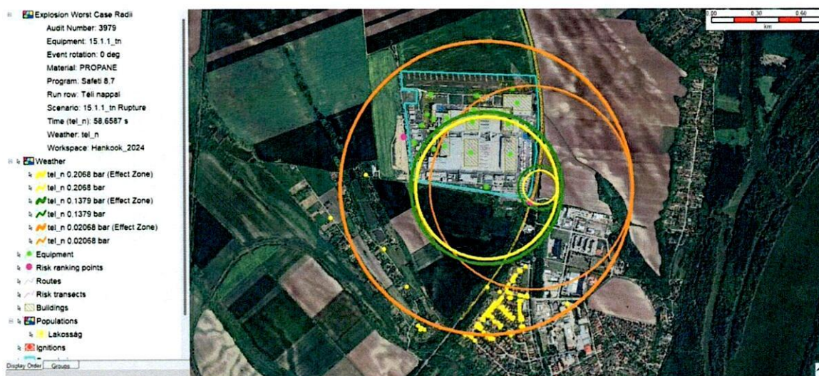
16. ábra: A 15.1.1_tn baleseti eseménysor bemutatása, robbanás hatása - 0,2 bar, 0,14 bar és 0,02 bar értékekhez tartozó túlnyomás görbék egy adott szélirány esetén (vékony görbék) és azok hatás területei (vastag görbék).
