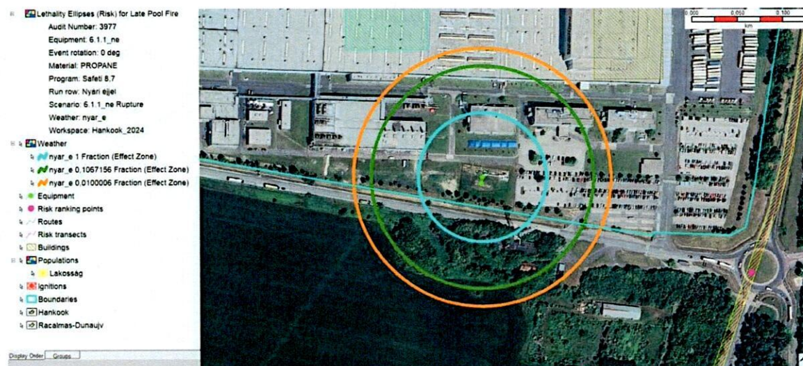
10. ábra: A 6.1.1_ne baleseti eseménysor bemutatása: késői tócsatűz 1%-os, 10%-os és 100%-os értékekhez tartozó halálozási ellipszisei.
