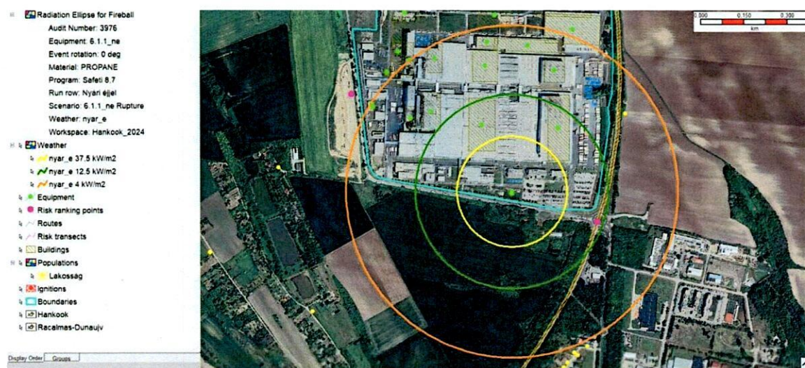
8. ábra: A 6.1.1_ne baleseti eseménysor bemutatása: tűzlabda 4 kW/m², 12,5 kW/m² és 37,5 kW/m² hőszugárzási értékekhez tartozó hatásgörbéi.
