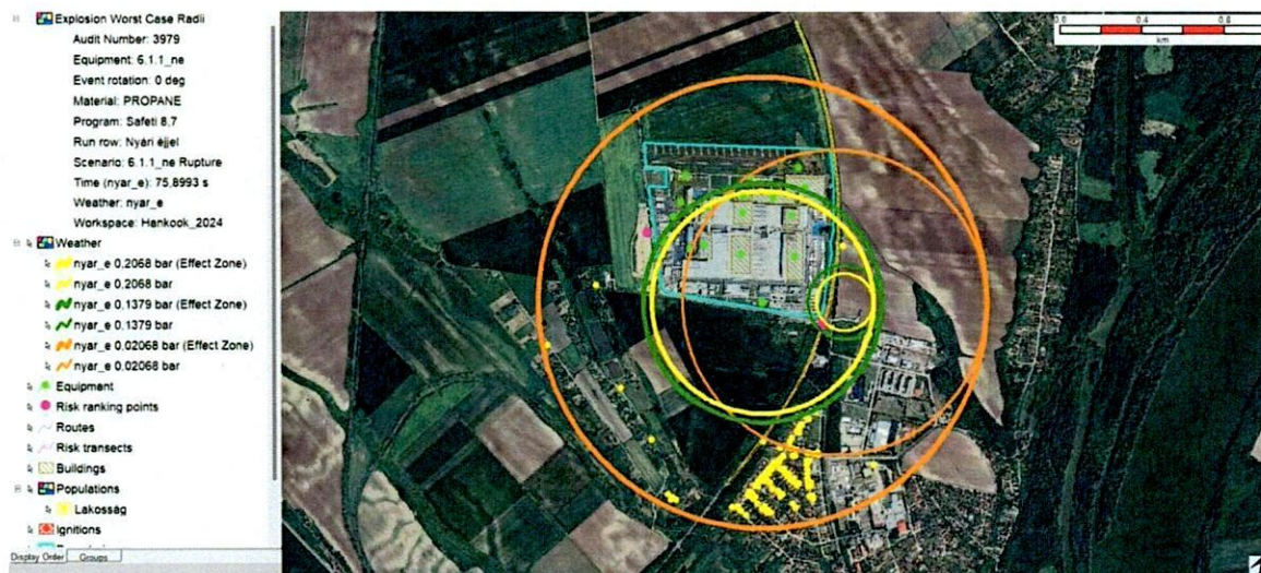
11. ábra: A 6.1.1_ne baleseti eseménysor bemutatása, robbanás hatása - 0,2 bar, 0,14 bar és 0,02 bar értékekhez tartozó túlnyomás görbék egy adott szélirány esetén (vékony görbék) és azok hatás területei (vastag görbék).
