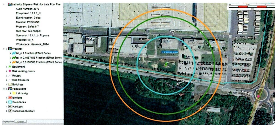
15. ábra: A 15.1.1_tn baleseti eseménysor bemutatása: késői tócsatűz 1%-os, 10%-os és 100%-os értékekhez tartozó halálozási ellipszisei.
