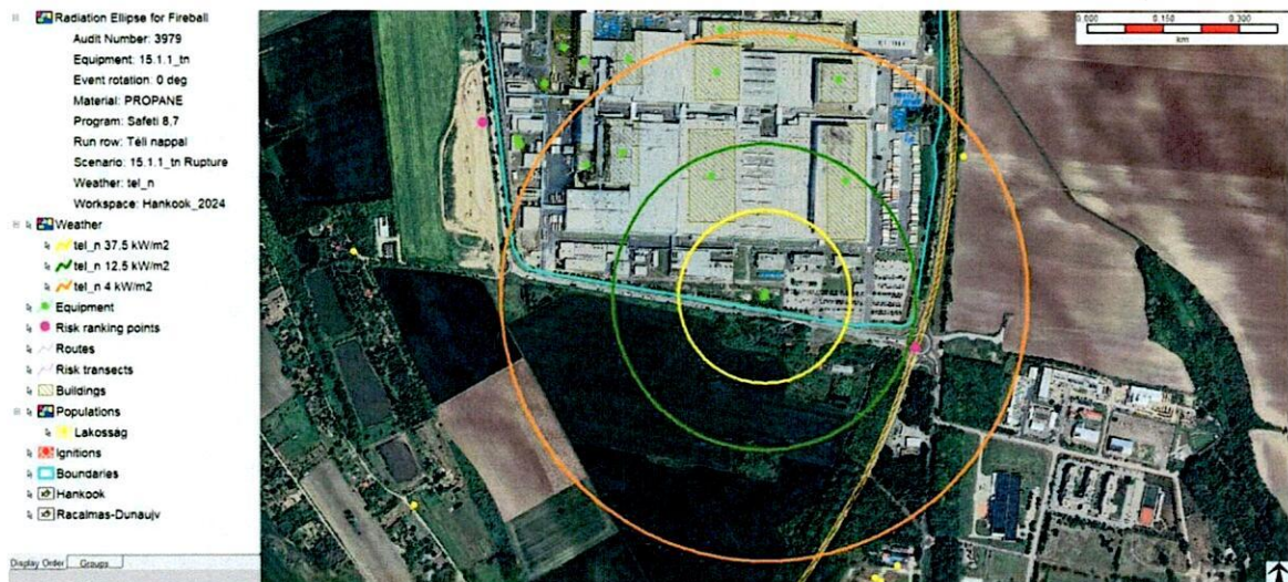
13. ábra: A 15.1.1_tn baleseti eseménysor bemutatása: tűzlabda 4 kW/m 2 , 12,5 kW/m 2 és 37,5 kW/m 2 hőszugárzási értékekhez tartozó hatásgörbéi.
